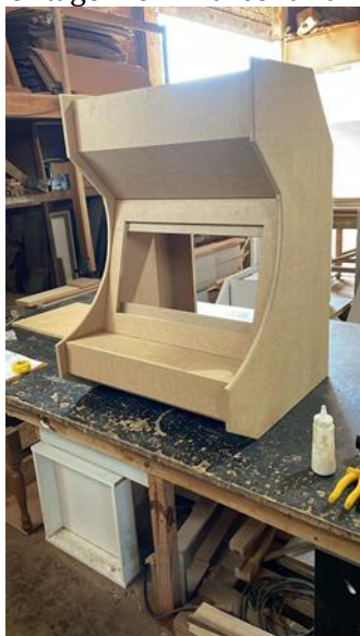
Figura 1 - Estrutura de fliperama em MDF em fase de montagem em marcenaria
